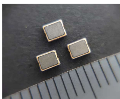
図 1 開発した 32kHz クロック用 CTGS 発振器 (2520 サイズ)
